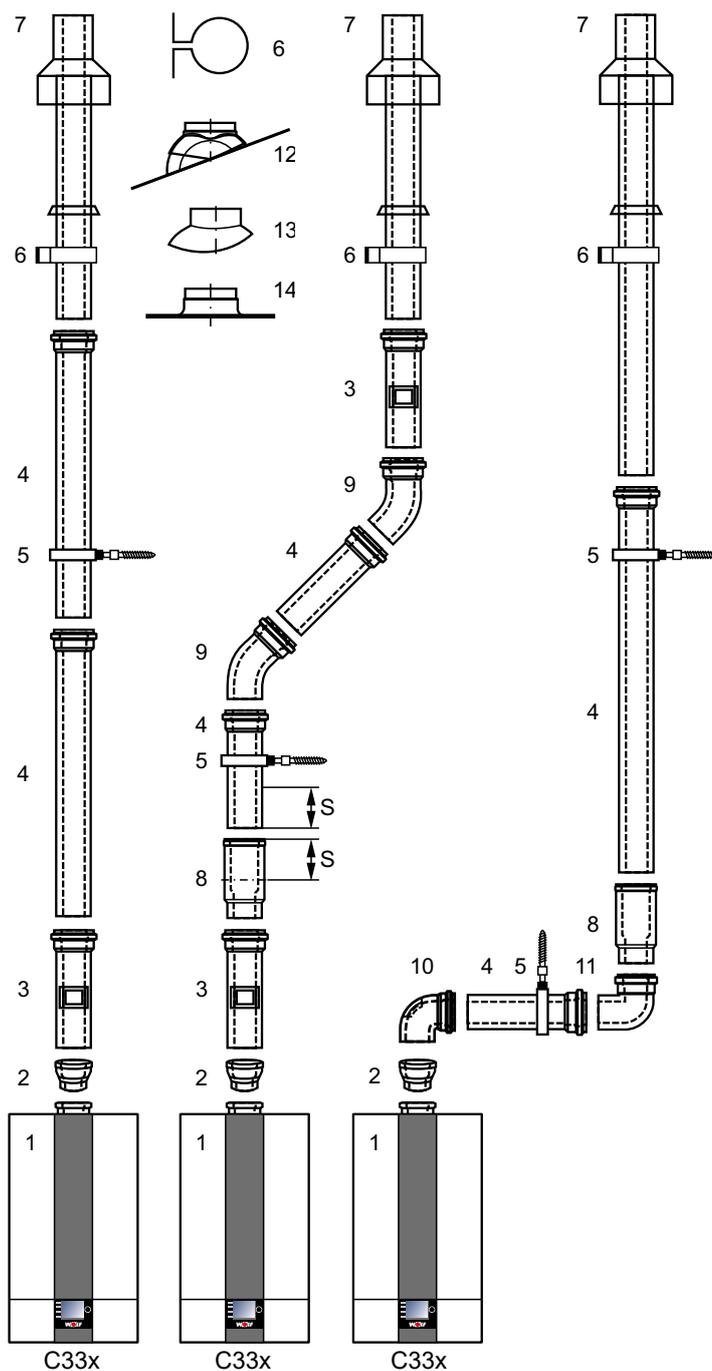
**Вид С33х:** Газовый конденсационный котел с подводом воздуха для горения и отводом ОГ вертикально через крышу.
