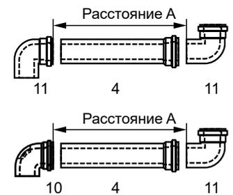
Определить расстояние А. Длина воздуховода/дымохода (4) всегда на прим. 100 мм длиннее расстояния А. Трубу ОГ всегда укорачивать с гладкой стороны, не со стороны муфты. После укорачивания снять фаску с трубы ОГ напильником.
