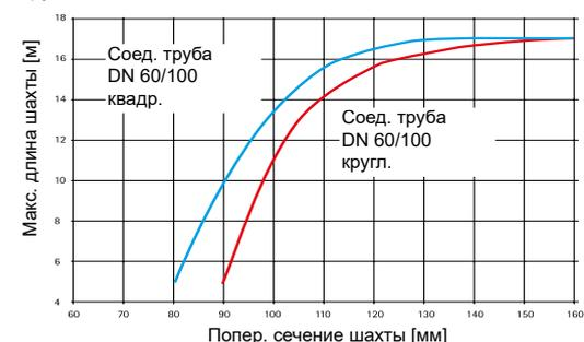
**Подсоединение к влагостойкому воздуховоду/дымоходу (LAS), дымовой трубе или системе для отвода ОГ, вид С 43х**
