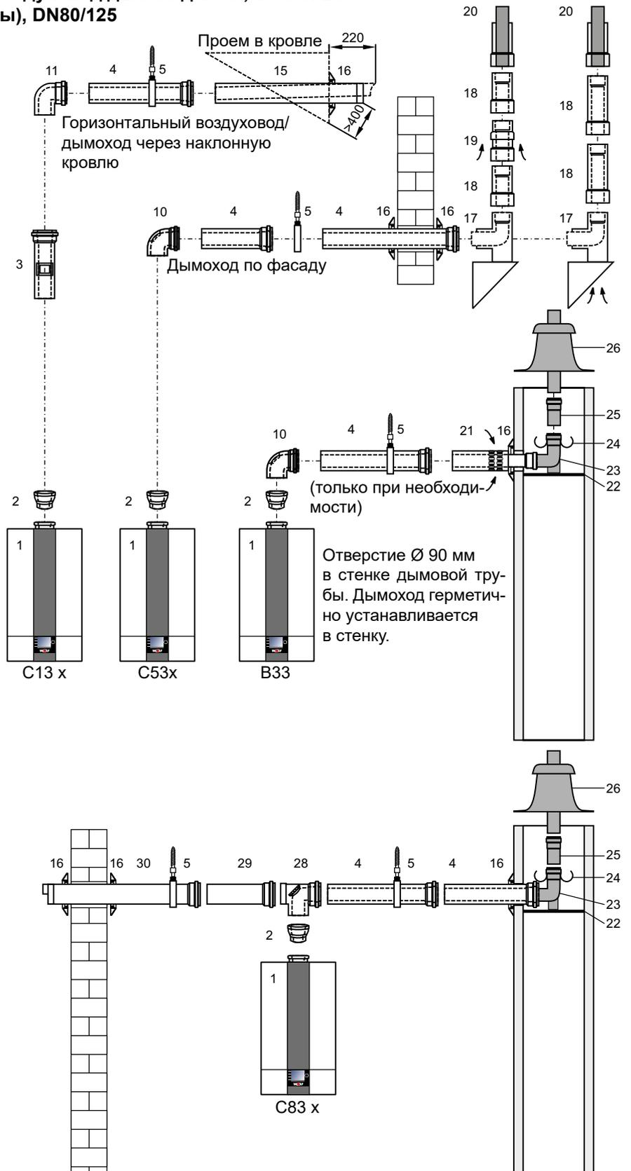
Горизонтальный дымоход монтируется с уклоном около 3° (6 см/м) к установке. Горизонтальный воздуховод прокладывается с уклоном около 3° наружу. Место всасывания воздуха следует защитить от ветра. Допустимое давление ветра на входе воздуха 90 Па, так как при большем давлении ветра работа горелки невозможна. В шахте после опорного колена (23) можно установить дымоход DN80. Гибкий дымоход DN83 можно подсоединить после опорного колена (23).
