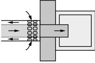
Подсоединение к дымовой трубе с отверстиями для воздуха должно устанавливаться непосредственно на дымовой трубе согласно рисунку, чтобы все части системы отвода ОГ обдувались воздухом для горения.
