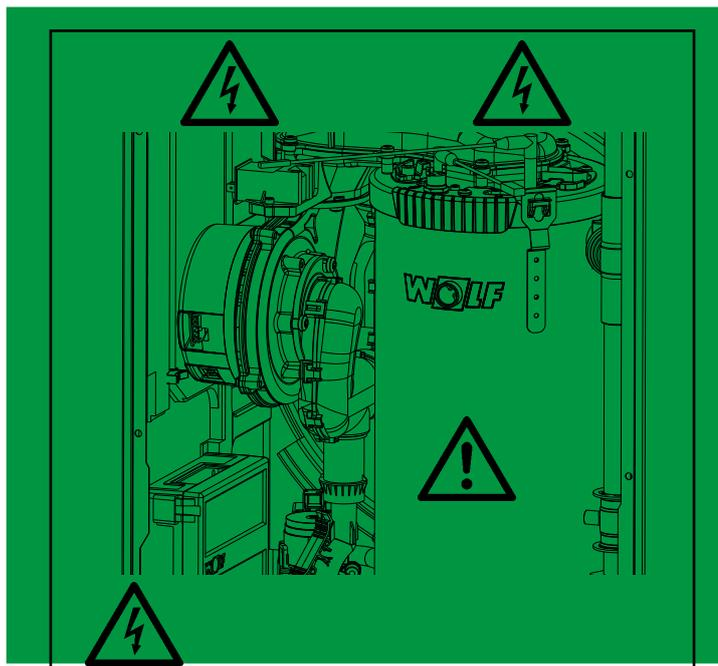
Трансформатор розжига, высоковольтный электрод розжига, камера сгорания: опасность поражения электрическим током, опасность ожогов из-за горячих деталей
