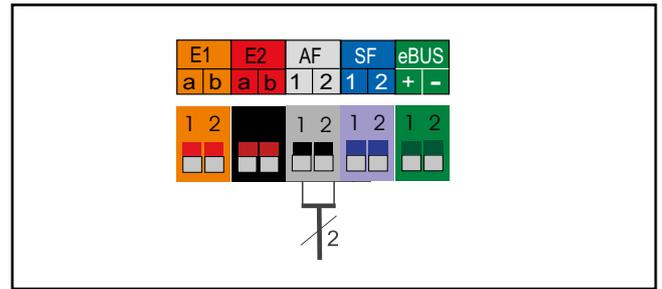
Подключение наружного датчика
