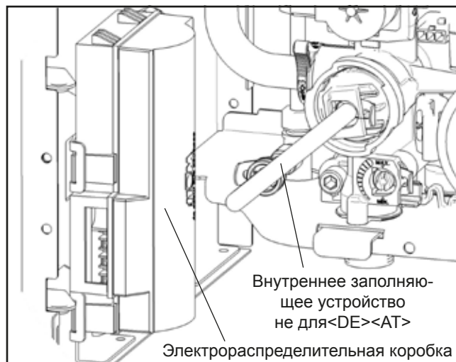
Рисунок: Электрораспределительная коробка
